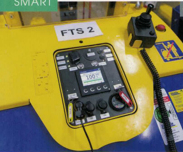
02 Das gut ablesbare Display mit einer Auflösung von 320 \times 240 Pixel ist optimal für die Visualisierung
