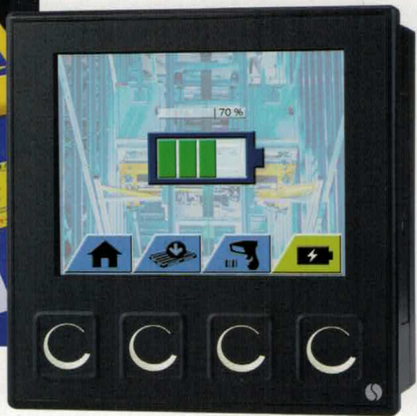
02 Das gut ablesbare Display mit einer Auflösung von 320 \times 240 Pixel ist optimal für die Visualisierung
